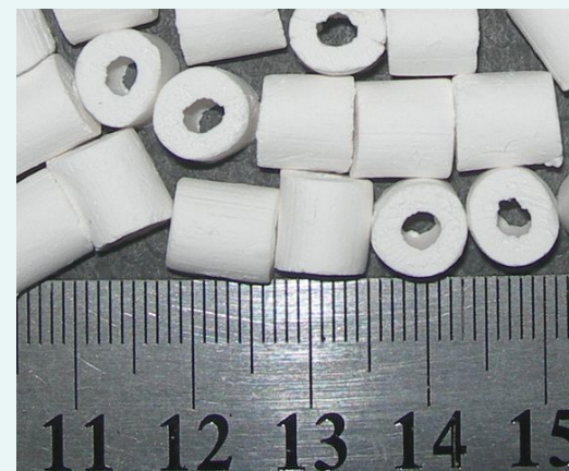
катализатор марки АОК ТУ 6-68-146-02; АО «Катализатор», г. Новосибирск, Россия
