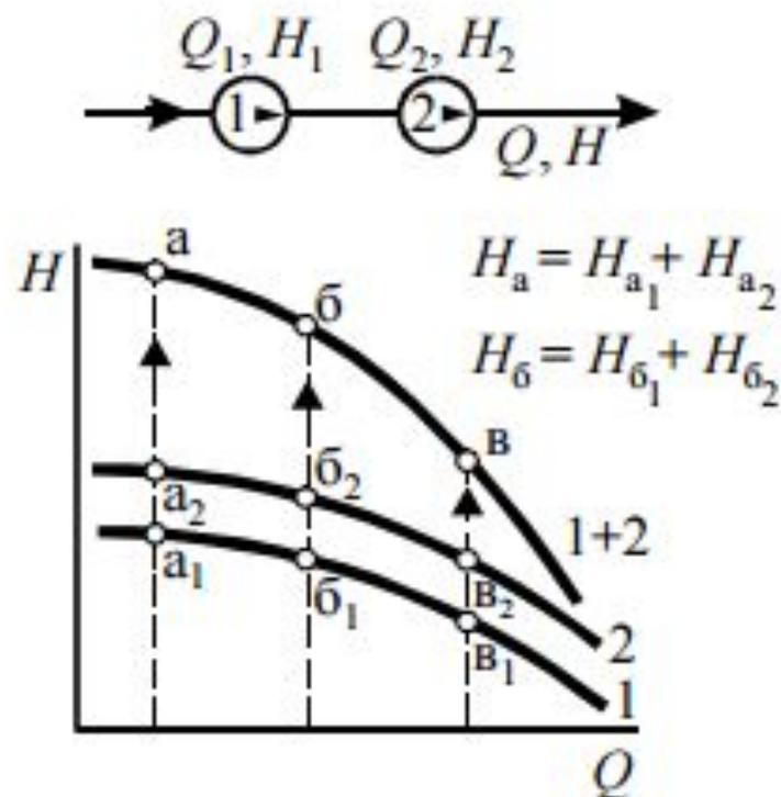
Рис. 7.2. Последовательное соединение и построение суммарной напорной характеристики
