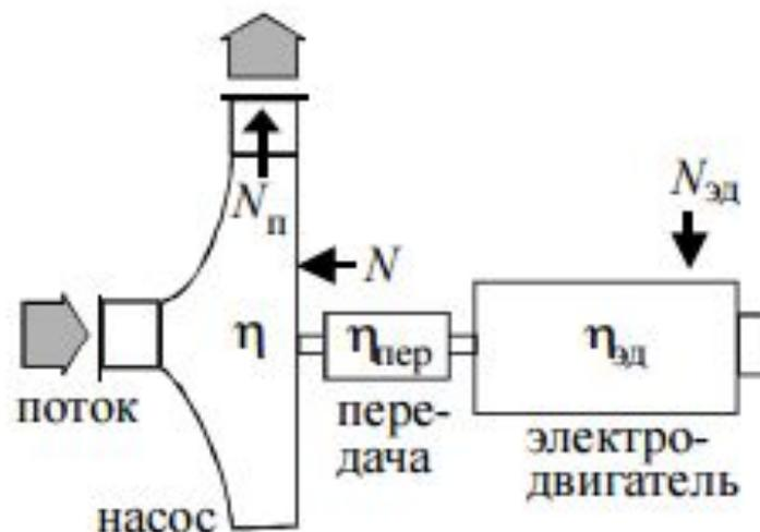
Рис. 2.1. Потери энергии в насосной (вентиляторной) установке
