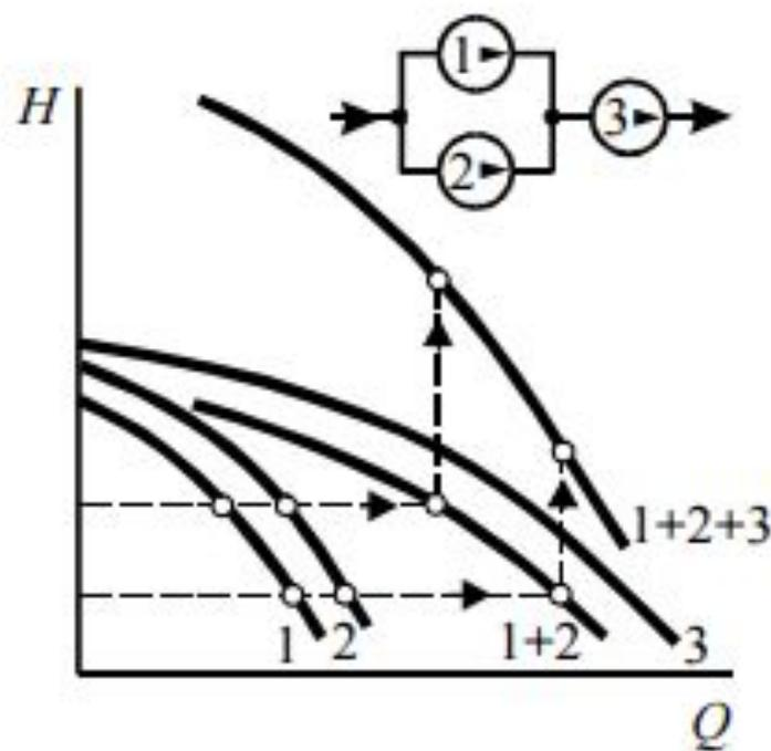
**Рис. 7.3. Смешанное соединение и построение суммарной напорной характеристики**
