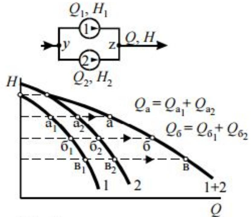
Рис. 7.1. Параллельное соединение и построение суммарной напорной характеристики
