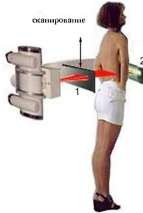
Схематичное изображение сканирующего метода 1 – коллиматор 2 – однокоординатный детектор
