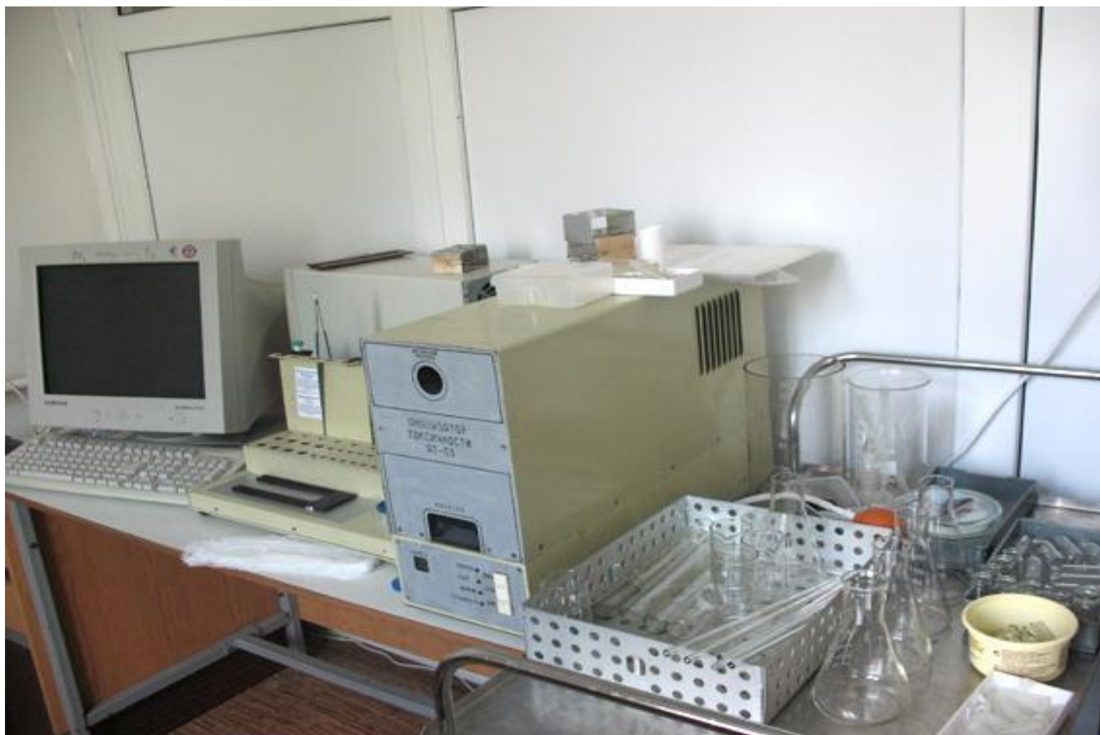
Анализатор токсичности, используемый для исследований на токсичность и апирагенность
