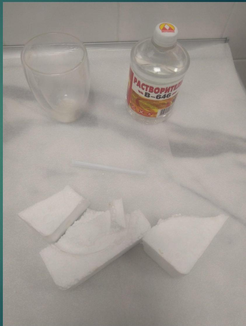
2. Берём ацетон, наливаем в стеклянную чашку. Далее ломаем пенопласт на небольшие части и погружаем его в ацетон. Пенопласт начинает растворяться.
