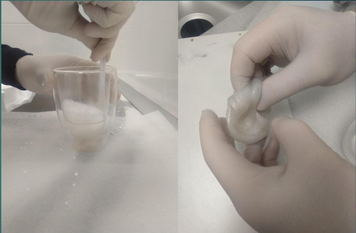
5. После испарения из нашей массы ацетона она затвердевает, превращаясь в пластмассовое изделие с едким запахом ацетона или как в моем случае растворителя.
