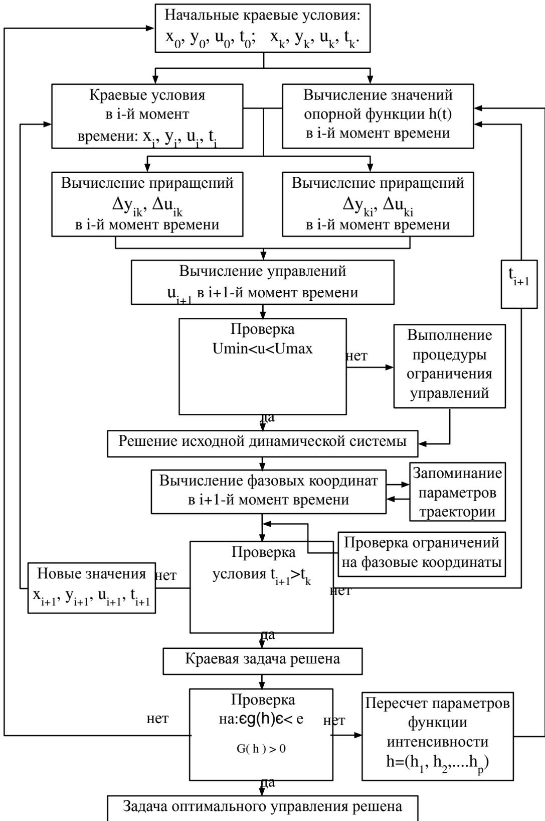
Рис.6.14. Схема алгоритма применения метода прямой оптимизации.
