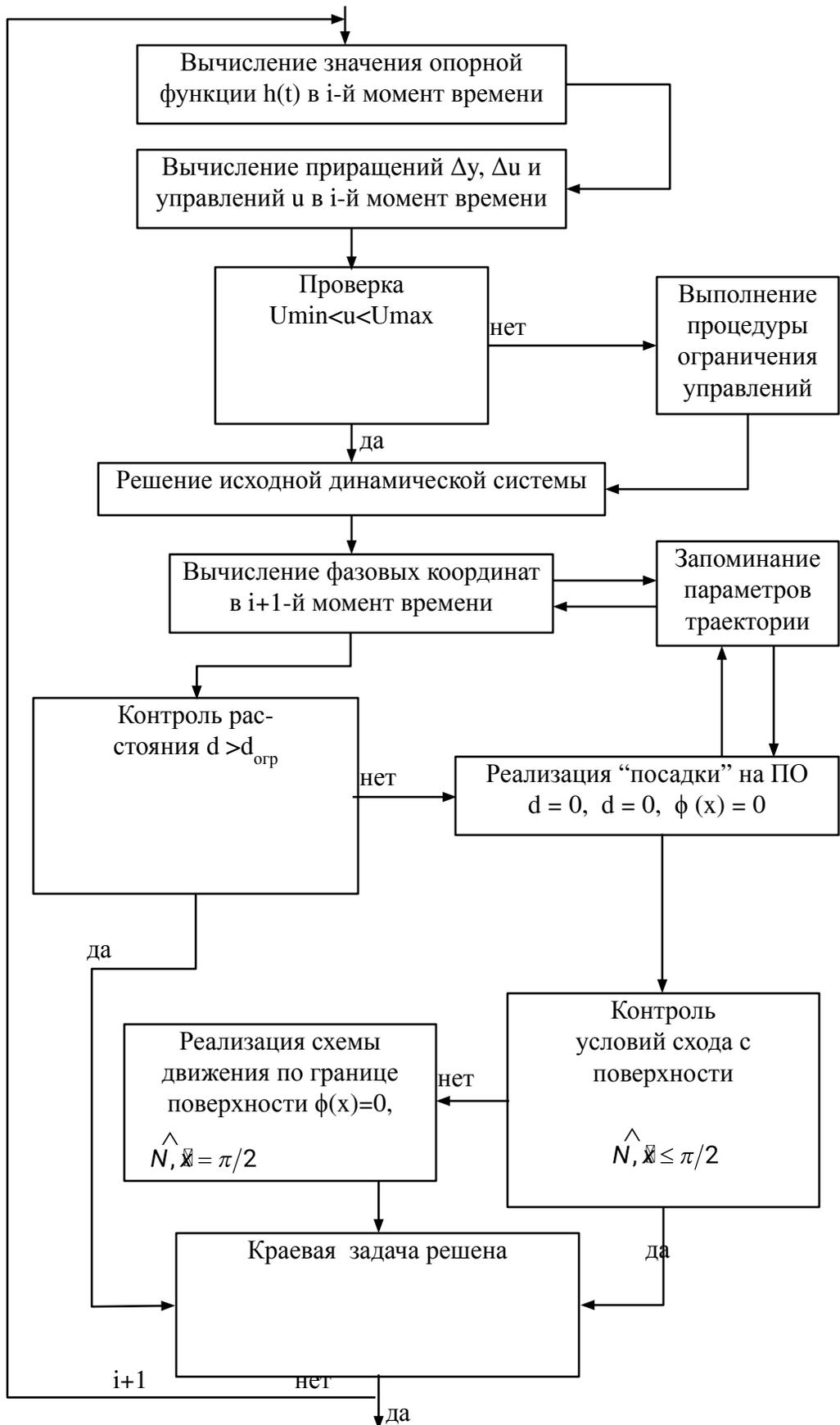
Рис.6.4 Блок-схема алгоритма выдерживания ограничений
