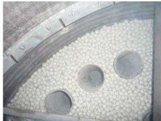
Рисунок 6. Двухсекционный реактор гидроочистки дизельного топлива
