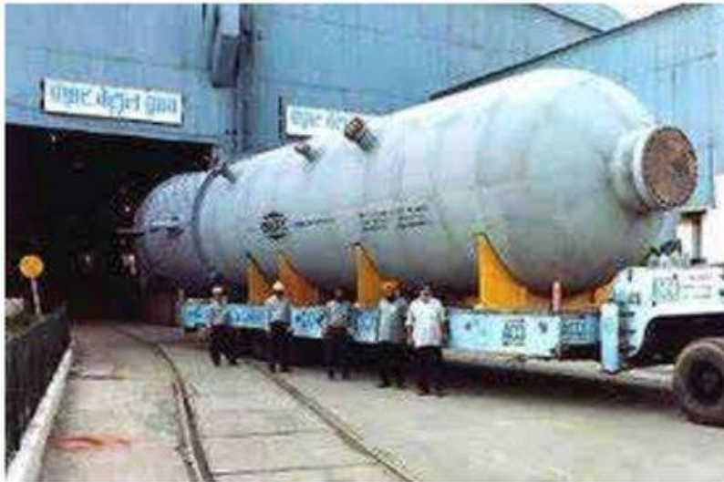
Рисунок 8. 130-ти тонный реактор гидроочистки дизельного топлива
