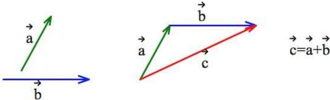
Если векторы  $\vec{a}$  и  $\vec{b}$  отложить последовательно друг за другом (начало вектора  $\vec{b}$  попадает в конец вектора  $\vec{a}$ ), то вектор суммы  $\vec{c}$  соединяет начало одного вектора с концом второго вектора.
