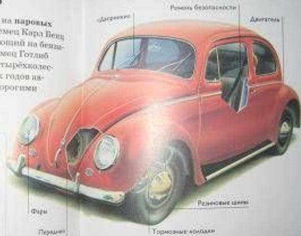
Первый автомобиль-жук был выпущен в 1936 году. В отличие от других автомобилей двигатель у него расположен в задней части корпуса.
