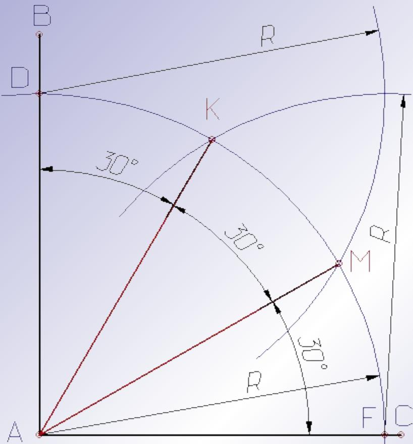
Из полученных точек проводят две дуги тем же радиусом  $R$ , до взаимного пересечения с дугой  $DF$  в точках  $K$  и  $M$ ; Точки  $K$  и  $M$  соединяют с вершиной  $A$  прямыми, которые разделят угол  $ABC$  на три равные части.
