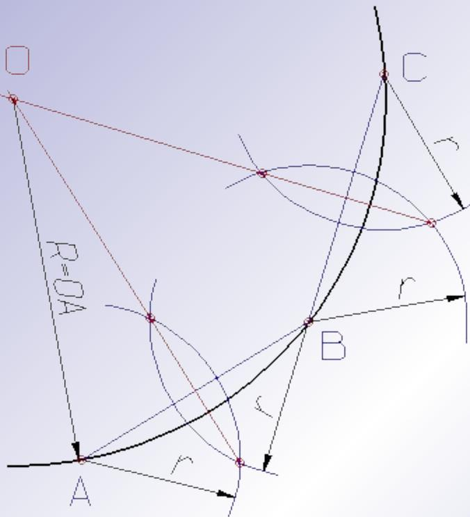
3. Точка **O** пересечения перпендикуляров определяет положение центра дуги, а отрезок **OA** равен радиусу дуги.
