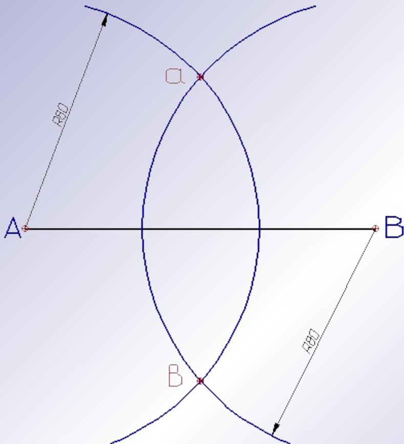
Из концов отрезка  $A$  и  $B$  циркулем проводят две дуги окружности радиусом  $R$ , несколько большим половины отрезка, до взаимного пересечения в точках  $a$  и  $b$ .
