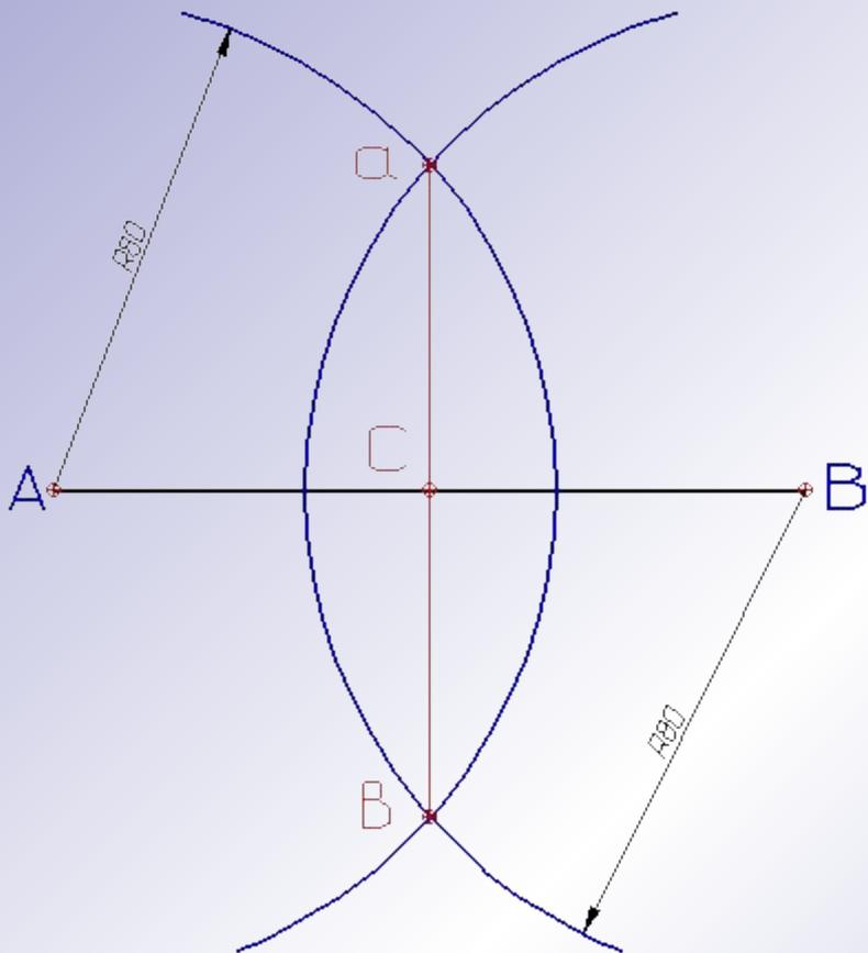
Через полученные точки **a** и **в** проведем прямую, которая пересекает отрезок **AB** в точке **С**, делящей отрезок на две равные части.
