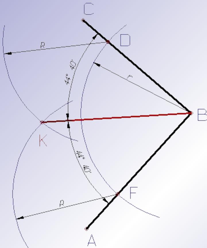
Из полученных точек проводят две дуги радиусом  $R$ , величина которого больше половины длины дуги  $DF$ , до взаимного пересечения в точке  $K$ ;
