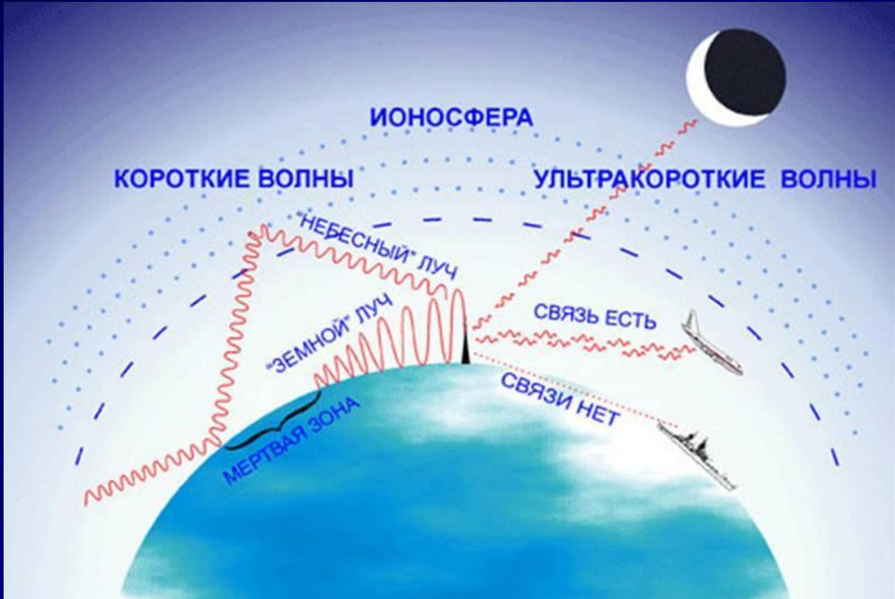
Радиоволна – электромагнитное излучение, распространяемое в пространстве со скоростью света, в котором длительность распространения и количество информации зависит от мощности источника перед информацию соответствующим устройствам.
