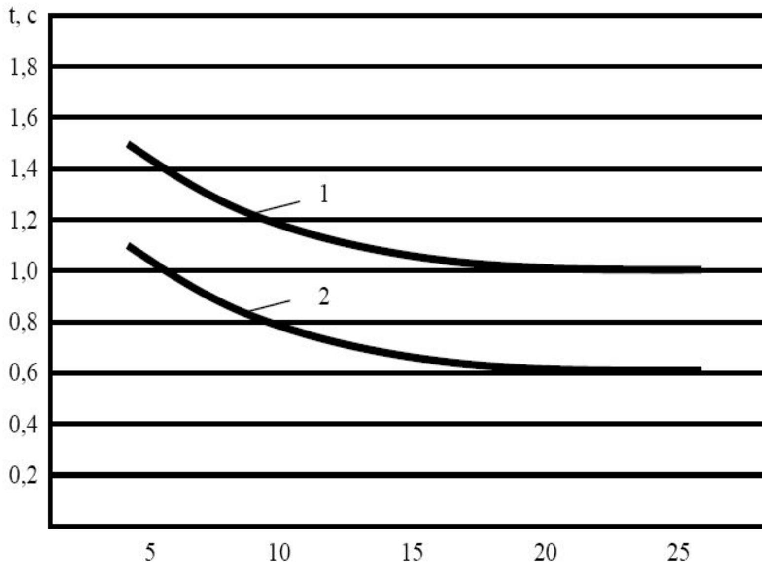
Изменение среднего времени реакции водителя ( $t$ ) в зависимости от стажа его работы: 1 – на маневрирование; 2 – на торможение.
