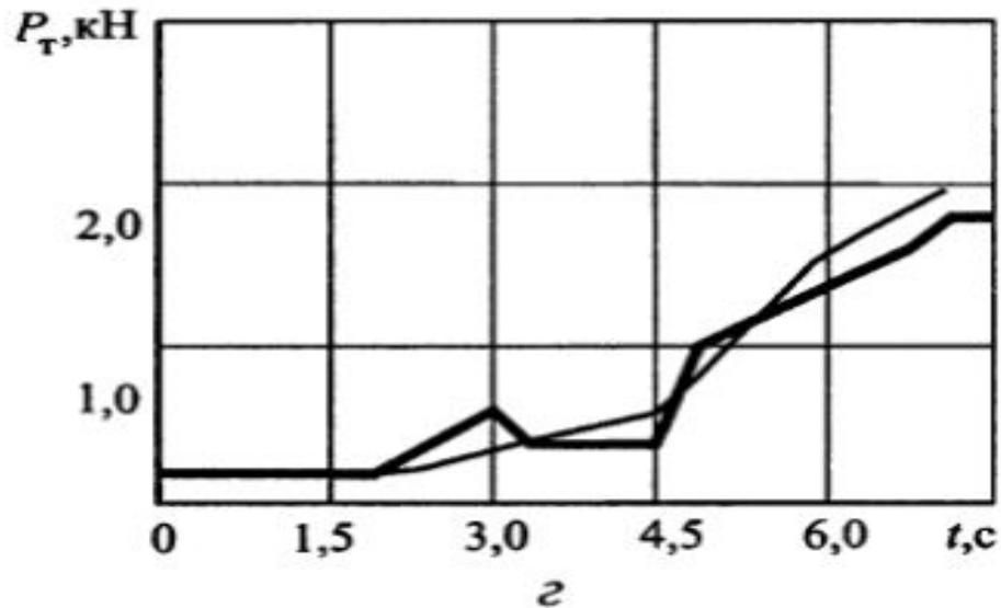
Рис. 2.12. Графики тормозного усилия и времени блокировки ведущих колес при разных пробегах:
