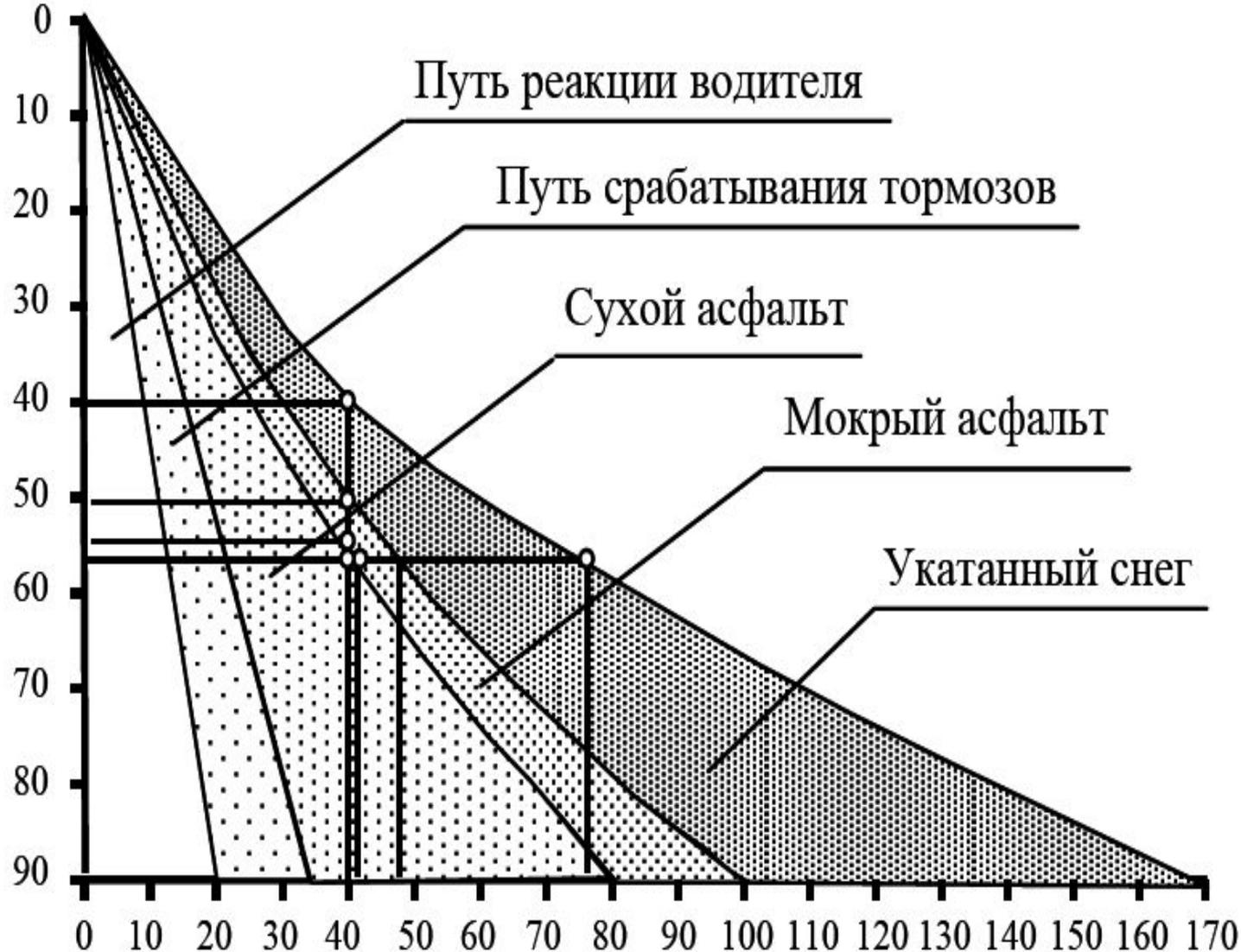
Рис. 4.4. Остановочный путь автомобиля в зависимости от скорости движения и состояния дорожного покрытия
