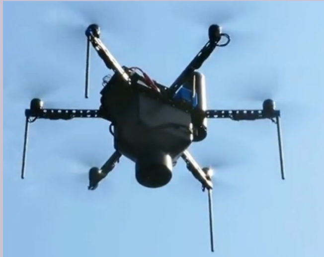
Дрон, що оснащений бункером для внесення трихограми в
