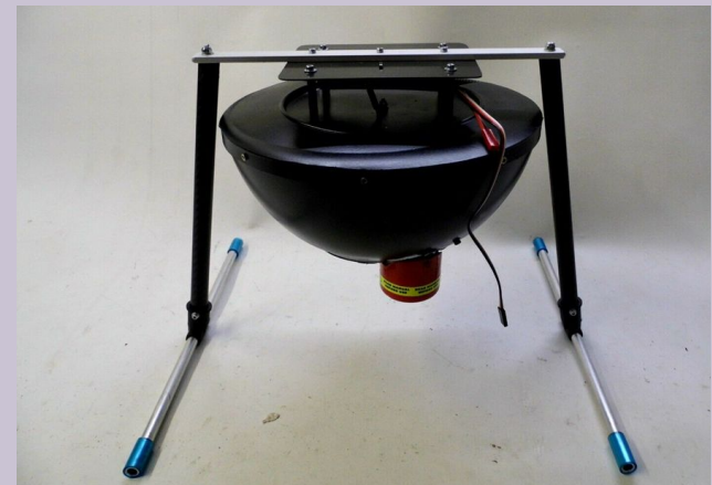
Бункер квадрокоптера для внесення трихограми в капсулах 11
