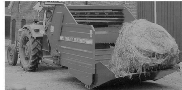
Кормораздатчик Multifeed KDW-HR фирмы "Trioliet"
