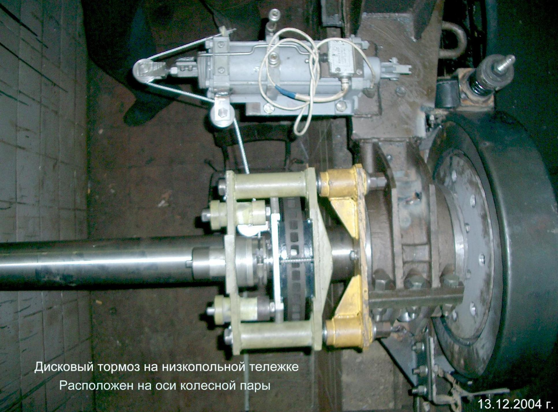
Дисковый тормоз на низкопольной тележке
