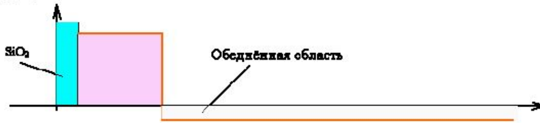
Рис.2а. Распределение зарядов в скрытом канале.
