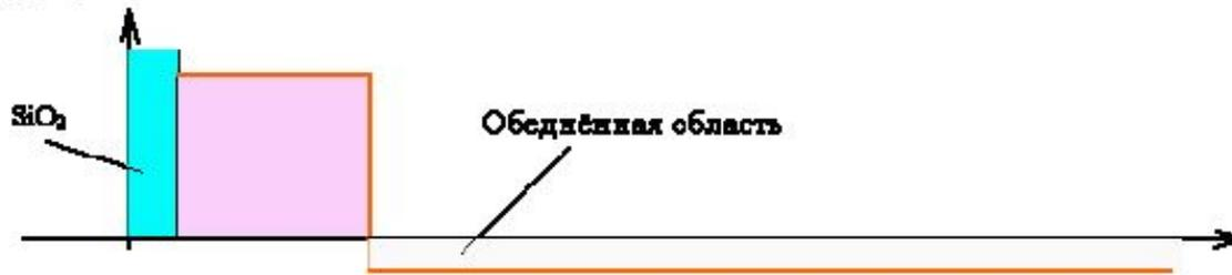
Рис.2а. Распределение зарядов в скрытом канале.
