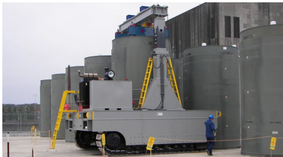
Транспортер металлобетонных контейнеров с ОЯТ по технологии Holtec
