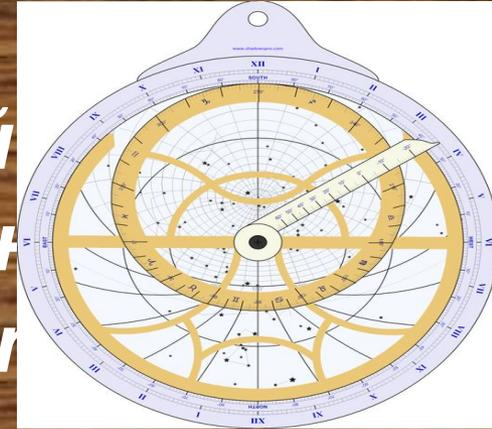
3) «паук» — круглая фигурная решётка, на которой в этой же стереографической проекции с помощью изогнутых спиц указано расположение самых ярких звезд расположенных севернее южного тропика
