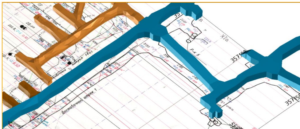
Рис.7 – Трехмерный вид оцифрованных исторических горных выработок
