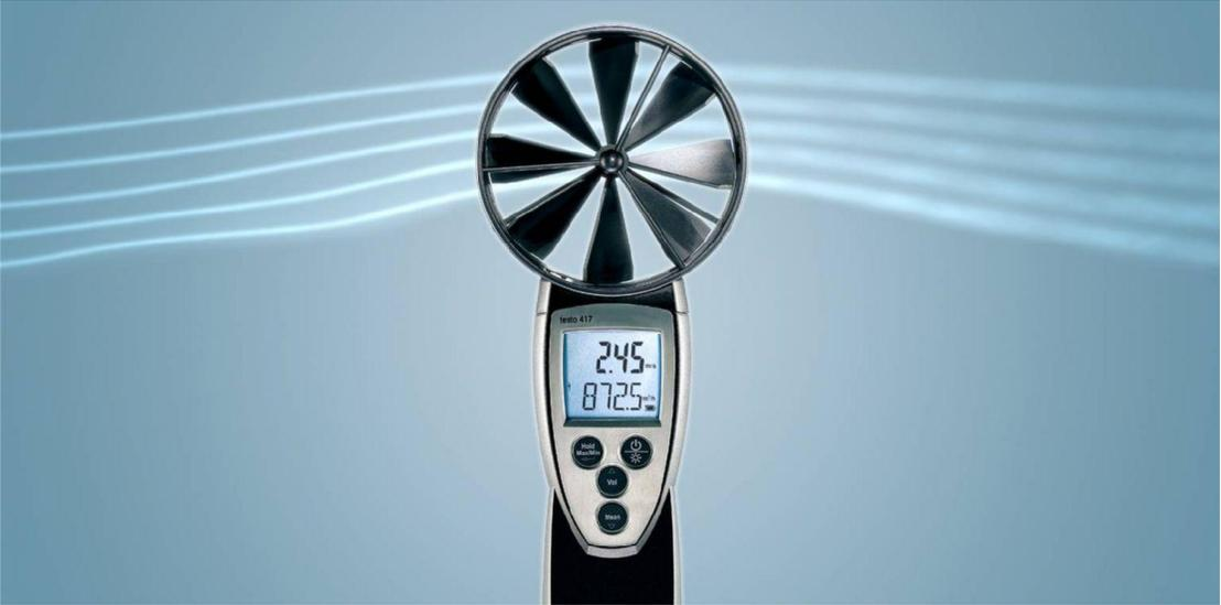
**Анемометром мы можем измерить только скорость воздушного потока, а контрольным параметром является расход, так что при замерах и при контроле применяем формулу:**
