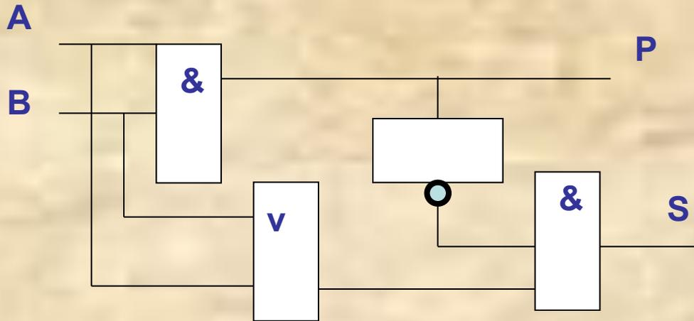
**Схема дает значение суммы двух величин и переноса в следующий разряд, но не учитывает сигнал переноса, полученный в предыдущем разряде. Отсюда название: полусумматор. Для получения сумматора нужно два полусумматора.**
