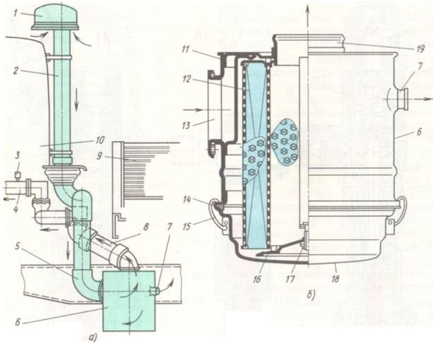
*a* – система подачи воздуха; *б* – воздухоочиститель; 1 – колпак; 2 – труба воздухозаборника; 3 – индикатор; 4 – левый впускной трубопровод; 5 – входная труба;
