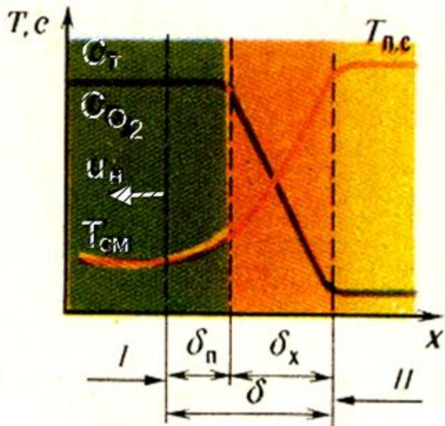
Рис. 55. Схема перемещения фронта пламени при турбулентности:
