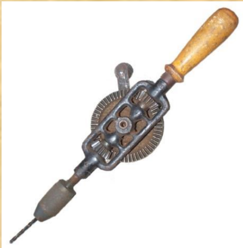
Зубчатый механизм ручной дрели
