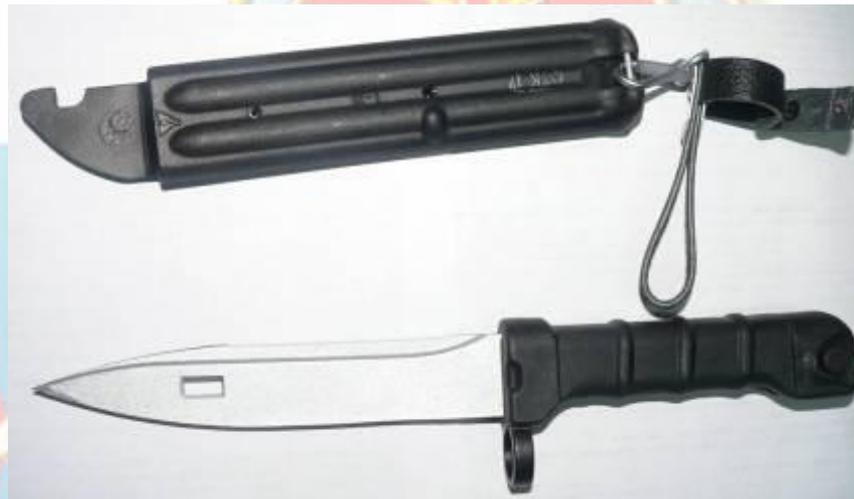
**Штык-нож** присоединяется к автомату перед атакой и служит для поражения противника в рукопашном бою, а также может использоваться в качестве ножа, пилы (для распиловки металла) и ножниц (для резки проволоки).
