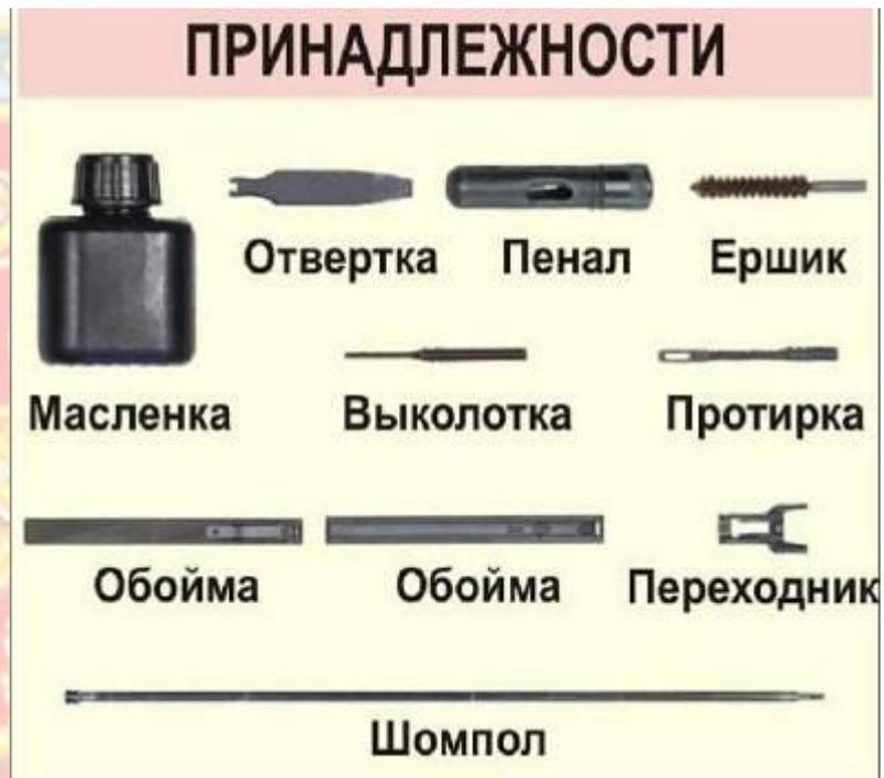
Принадлежности автомата предназначены для чистки и смазки, а также для разборки и сборки автомата.
