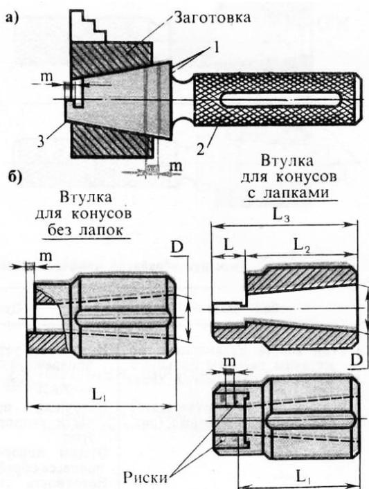
2. КОНУСНЫЕ КАЛИБРЫ: а — контроль внутренней конической поверхности (конуса) калибром-пробкой, б — калибры-втулки для контроля наружных инструментальных конусов; 1 — контрольные риски, 2 — рукоятка, 3 — пробка
