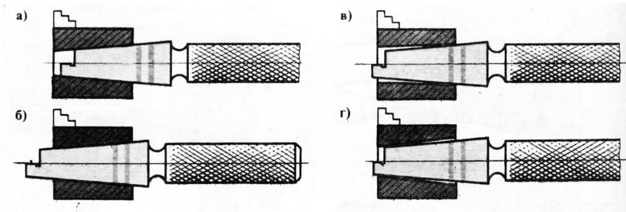
3. ВИДЫ БРАКА ПРИ ОБРАБОТКЕ ВНУТРЕННИХ КОНИЧЕСКИХ ПОВЕРХНОСТЕЙ: а, б — угол конуса правильный, но неточны размеры большого и малого оснований
