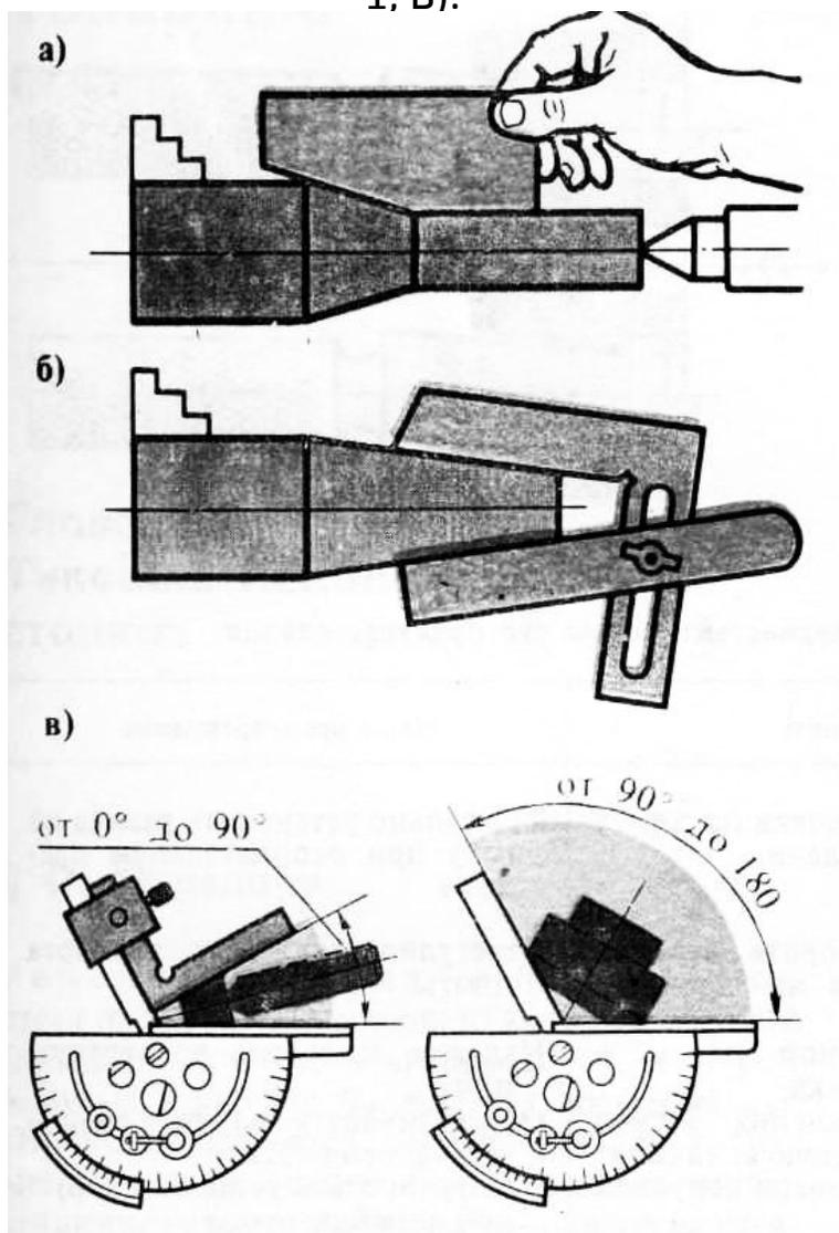
КОНТРОЛЬ УГЛА КОНУСА КОНИЧЕСКИХ ПОВЕРХНОСТЕЙ: а — жестким шаблоном, б — регулируемым шаблоном, в — универсальным угломером
