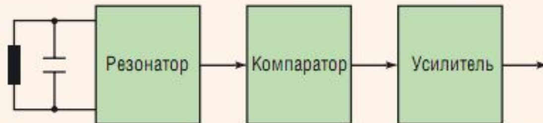
Устройство и функциональная схема индуктивного датчика
