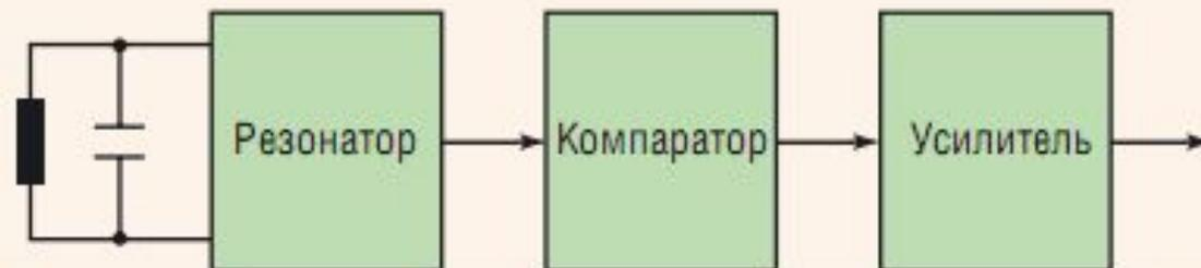
Устройство и функциональная схема индуктивного датчика
