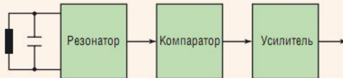
Устройство и функциональная схема индуктивного датчика
