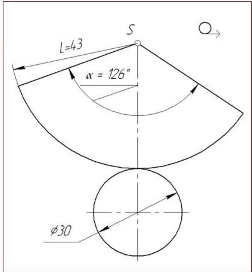
Развертка поверхностей конуса представляет собой плоскую фигуру, состоящую из сектора – развертки боковой поверхности и круга основания конуса. При определении размера угла  $\alpha$  - сектора конуса можно по формуле (смотрите рис.1)
