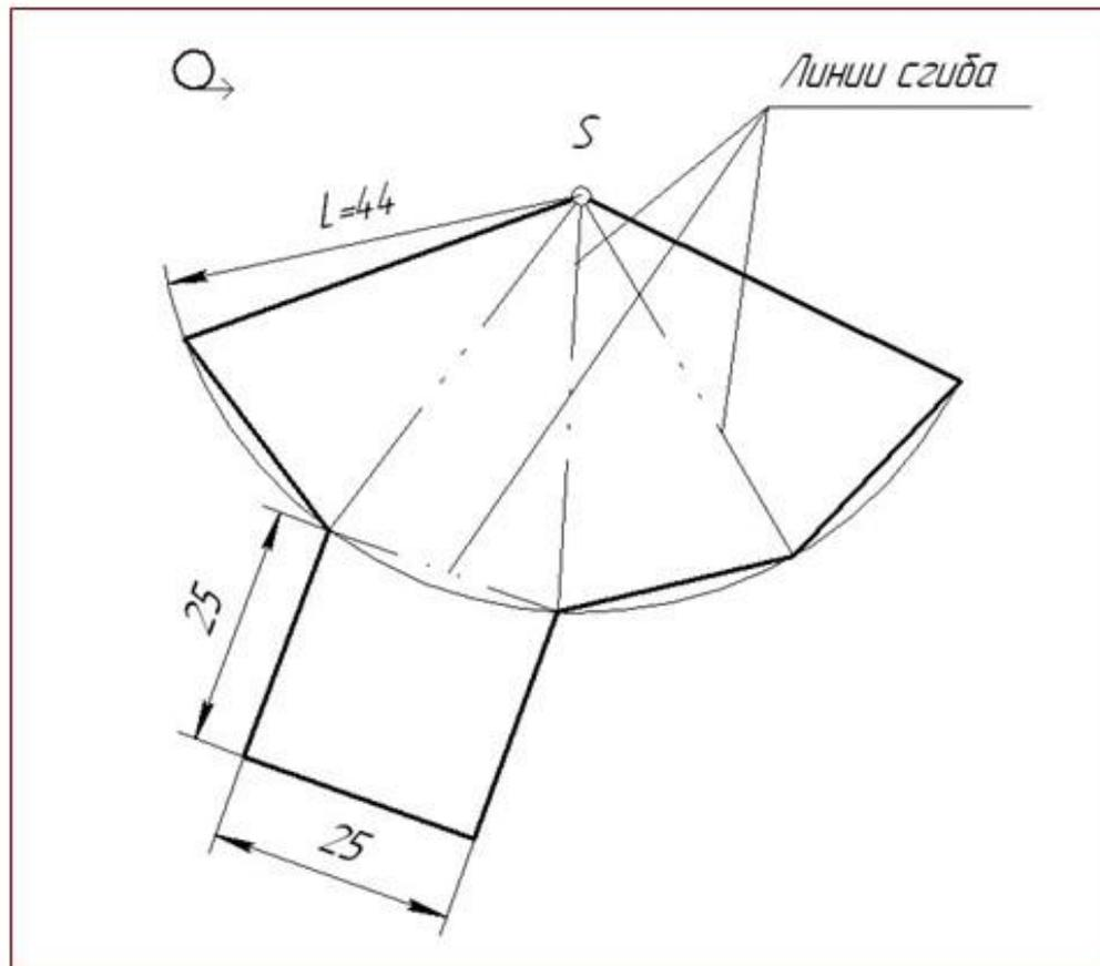
Развертка поверхностей правильной шестиугольной призмы представляет собой плоскую фигуру, составленную из боковых граней – четырех равносторонних треугольников при вершине  $S$  и основании – квадрат
