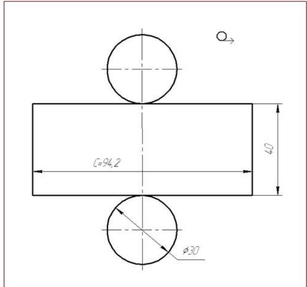
Развертка поверхностей цилиндра состоит из прямоугольника и двух кругов - оснований. Одна сторона прямоугольника равна высоте цилиндра, а другая - длине окружности основания. Длину окружности можно найти по формуле -  $C = \pi d$
