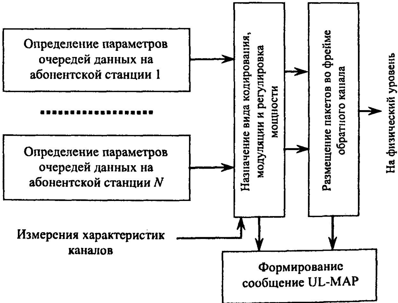
Рис. 2 — Функции MAC-уровня базовой станции при управлении передачей в обратном канале
