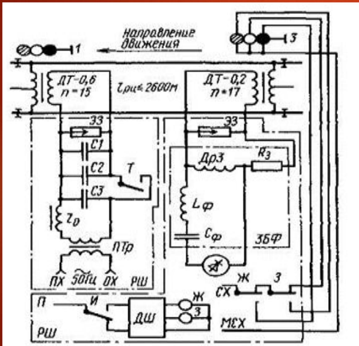
Числовую кодовую автоблокировку применяют на участках, электрифицированных на постоянном и переменном токе. При электротяге постоянного тока используют кодовые рельсовые цепи, работающие на сигнальной частоте 50 Гц (показано на рисунке 1), а при электротяге переменного тока — на сигнальной частоте 25 Гц (показано на рисунке 2). В остальной схеме автоблокировки идентичны.
