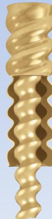
Ротор - подвижная внутренняя деталь, является геликоидом с одним заходом, то есть сформированным как простая винтовая поверхность. Он изготавливается из высокопрочной стали и гальванически покрывается твердым хромом, чтобы противостоять абразивному износу и химическому воздействию.
