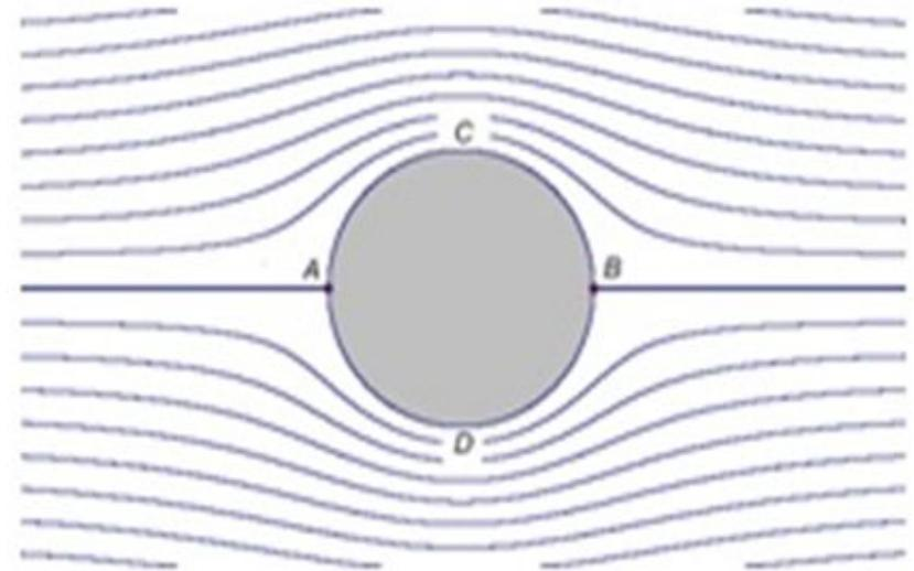
Рисунок 7.3 – Линии тока обтекания цилиндра (компьютерная реализация)
