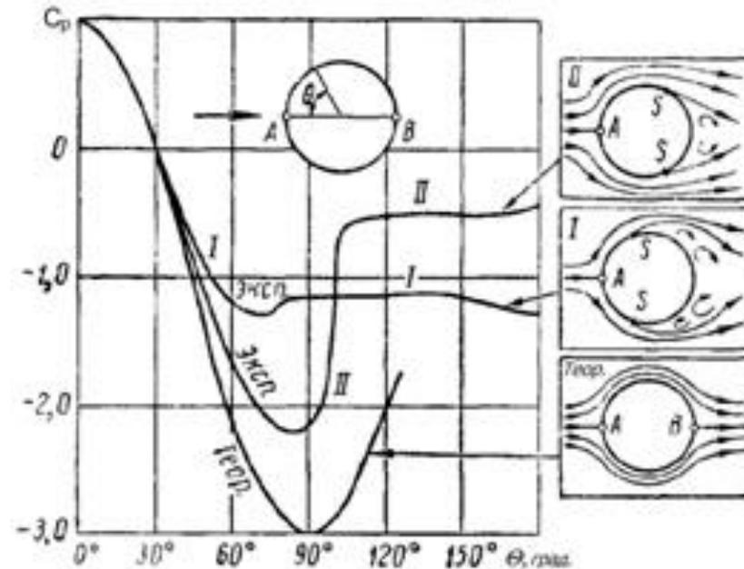
Рисунок 7.5 – Распределение давления по поверхности цилиндра
