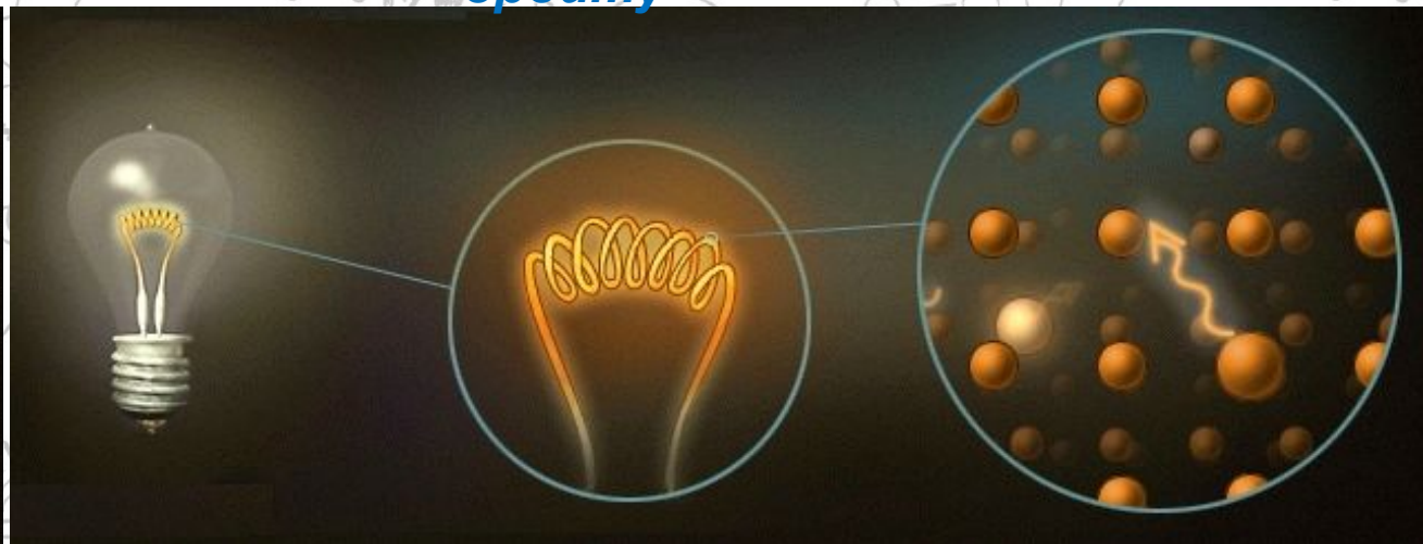
Испускание света при переходах электрона
