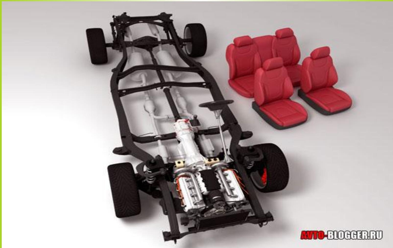
Рамная конструкция кузова — строение автомобиля, при котором все важные технические узлы и элементы крепятся на определенную жесткую раму.
