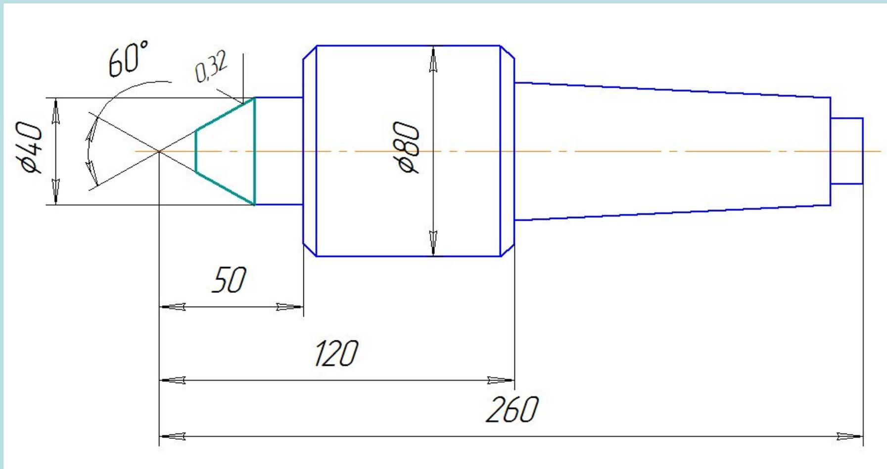
Рис. 9. Центр для токарного станка:
