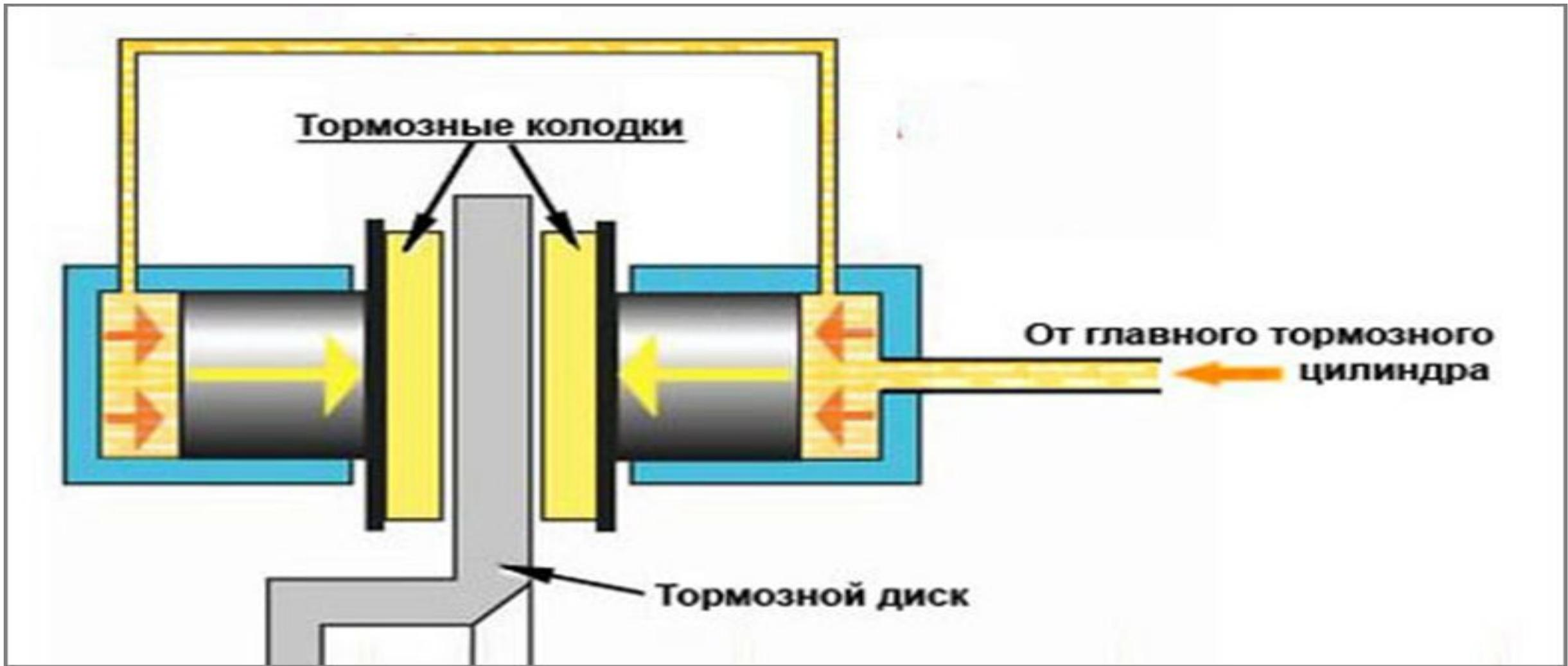
Повторяю, жидкость – тело несжимаемое и, следовательно, какой объём жидкости вы вытесните из главного тормозного цилиндра, такой же объём перетечёт в колёсные тормозные цилиндры. В результате жидкость прижмёт тормозные колодки к тормозным дискам.
