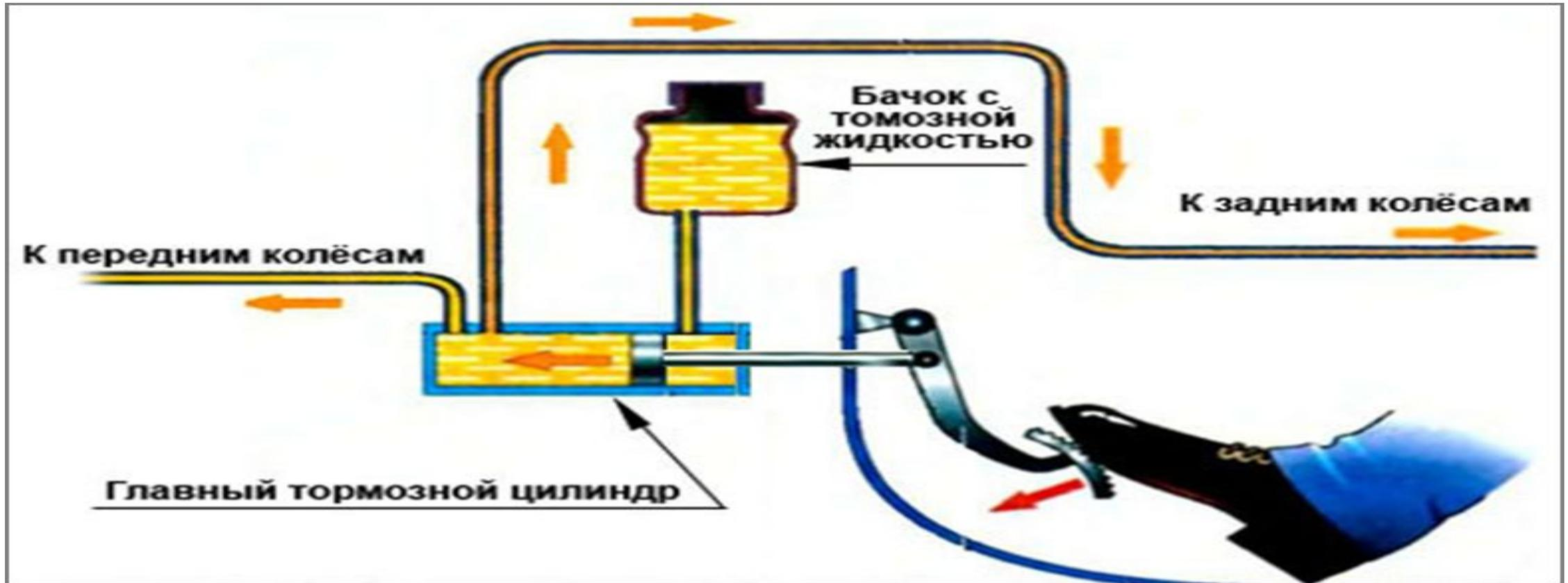
Когда вы нажимаете на педаль тормоза, вы всего лишь перемещаете поршень внутри главного тормозного цилиндра. Поршень, перемещаясь, вытесняет из цилиндра тормозную жидкость. А жидкость – тело несжимаемое, деваться ей некуда и она по шлангам и трубкам, расположенным под днищем автомобиля, перетекает к передним и задним колёсам.
