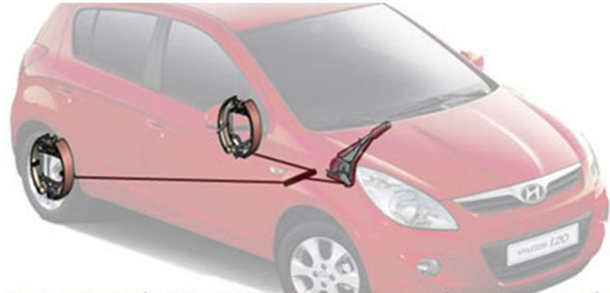
Во-первых, не вредно знать, что у большинства автомобилей ручник блокирует не все четыре колеса, а только два задних. И, как правило, изготовители применяют примитивнейший механизм привода – колодки прижимаются к тормозным барабанам с помощью системы, состоящей из рычагов, тяг и тросов, расположенных под днищем автомобиля.
