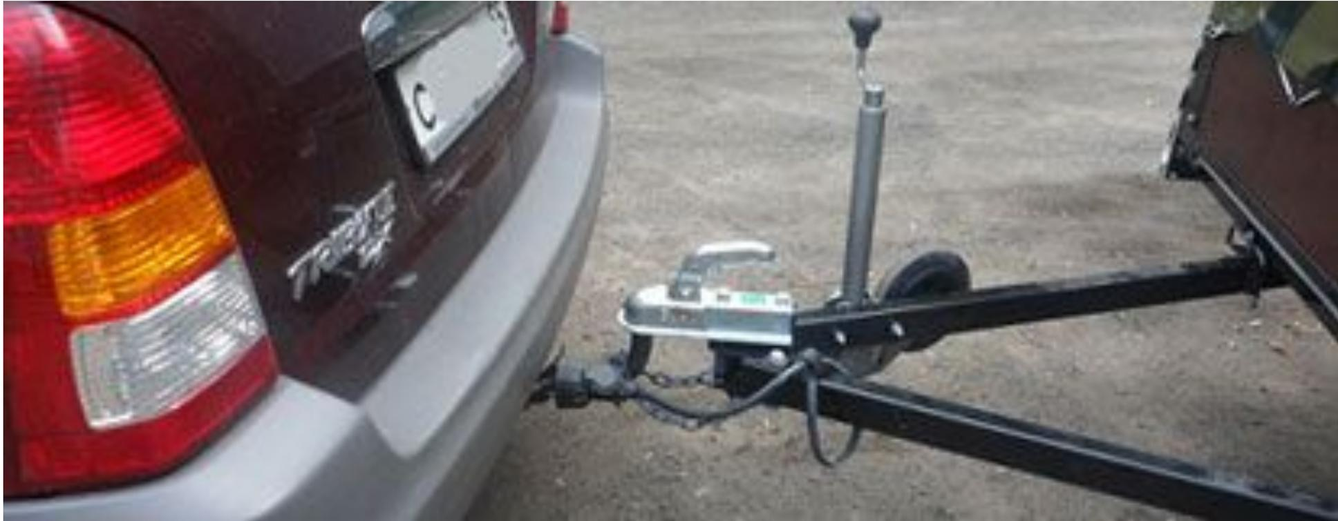
Речь идёт о тягово-сцепном устройстве, предназначенном для буксировки прицепов. Применительно к легковому автомобилю, это известное всем устройство по имени форкоп – сцепной шар диаметром 50 мм, на который накидывается ответная головка, смонтированная на дышле прицепа.
