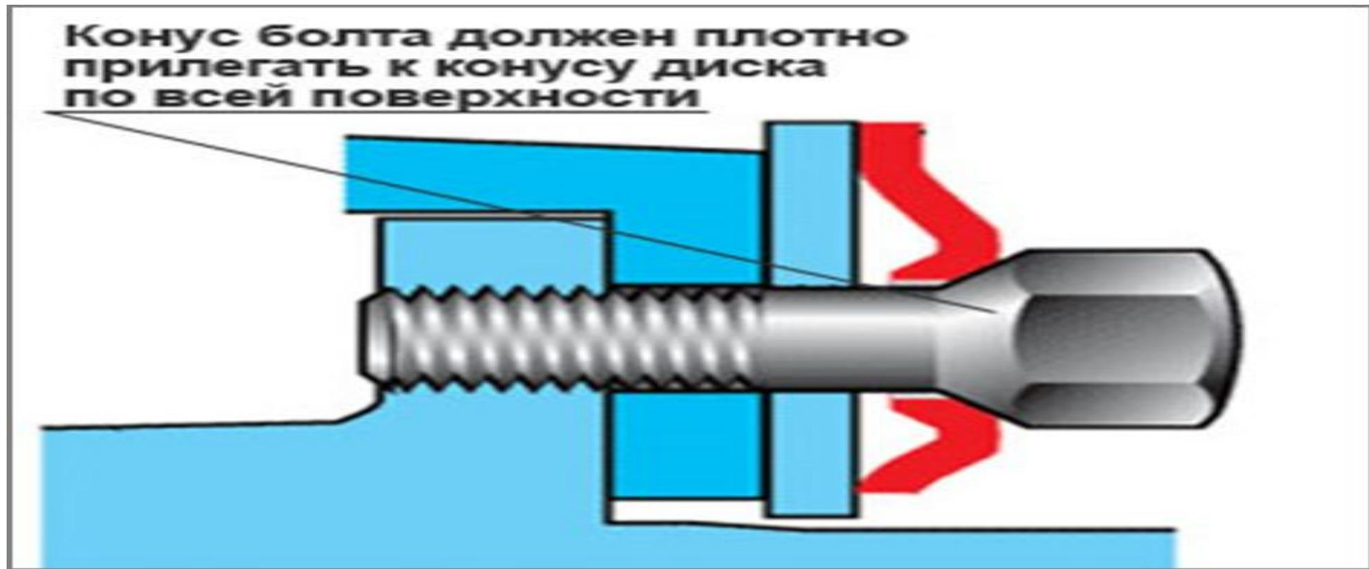
Колёсные болты они ведь не простые, а специальные. У них есть специальная коническая фаска. И такой же ответный конус сделан в колёсном диске. И такое коническое сопряжение как раз и гарантирует, что болт не открутится, и колесо на ходу не отвалится.
