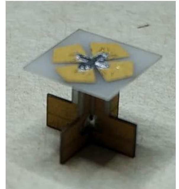
Экспериментальный образец (напыление на поликоре 0,2 мм, размер 4.5x4.5x5мм)
