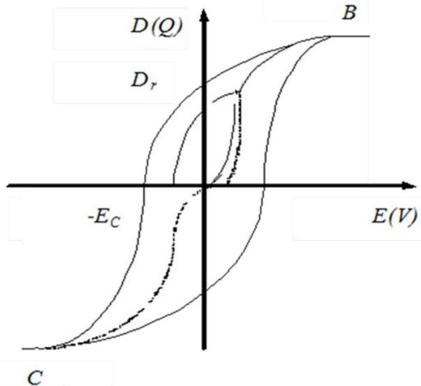
Рисунок 1 - Основная кривая поляризации сегнетоэлектрика и петля диэлектрического гистерезиса
