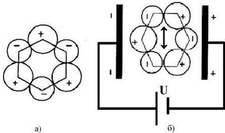
Рис.2. Схема структуры кварца (а) и возникновения обратного пьезоэлектрического эффекта(б)
