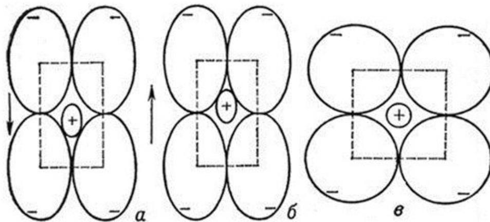
Рис. 1. Схематическое изображение элементарной ячейки сегнетоэлектрика в полярной фазе (а и б) и в неполярной фазе (в); стрелки указывают направление электрических дипольных моментов.
