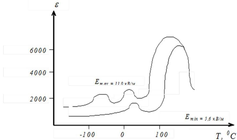
Рисунок 2 - Диэлектрическая проницаемость титаната бария в зависимости от температуры при различной напряженности электрического поля
