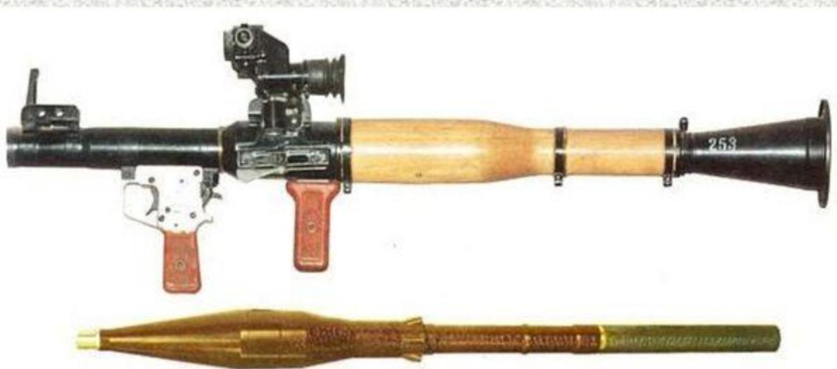
Ручний протитанковий гранатомет РПГ-7 і (РПГ-7Д) призначений для боротьби з танками, самохідно-артилерійськими установками іншими броньованими засобами противника. Крім цього, він може використовуватися для знищення живої сили противника, що знаходиться в легких укриттях, а також у спорудах міського типу.
