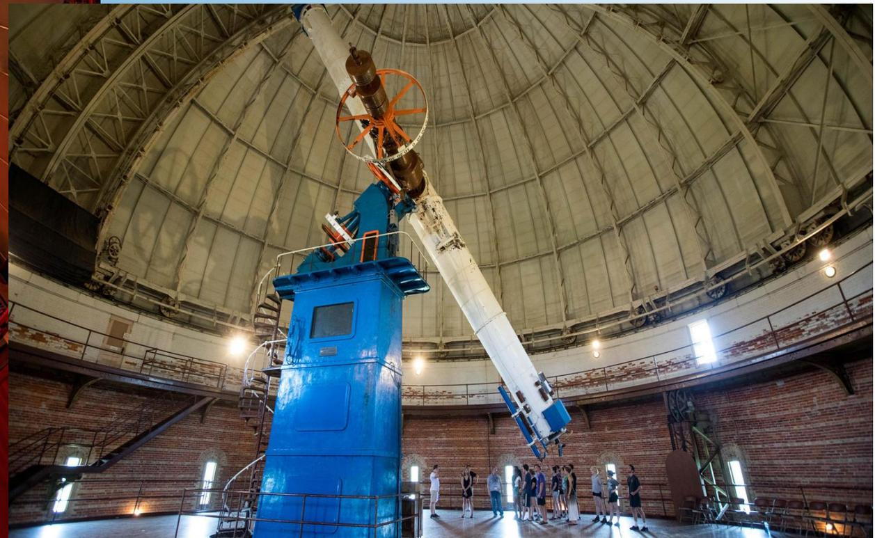
Дальнейшее увеличение диаметра объектива считается нецелесообразным из-за возможных механических деформаций тяжелых линз и значительного поглощения света, что заметно влияет на качество изображения. Поэтому объективы диаметром более 0,5 м делают зеркальными, а телескопы, использующие такие объективы, называют телескопами-рефлекторами
