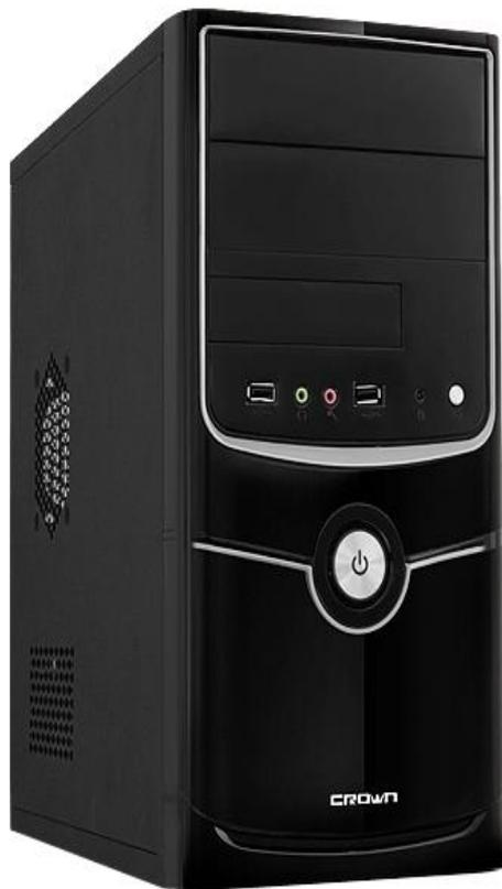
**Системный блок** – самая «умная» часть компьютера. В нем находятся управляющие и запоминающие устройства: процессор, оперативная (внутренняя) память, накопители на гибких и жестких магнитных носителях, блок питания. **Процессор** управляет всеми устройствами компьютера, выполняет программы, обрабатывает данные, находящиеся в оперативной
