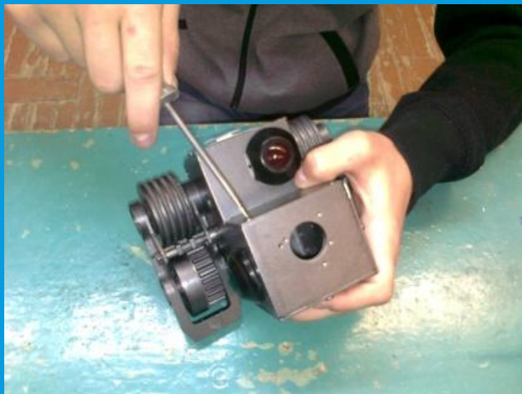
Монтаж блока колес, шасси Мотор-колесо.
