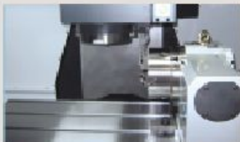
Установка дополнительной оси
