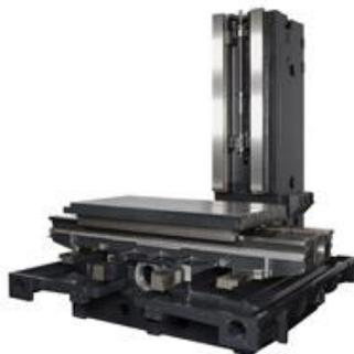
Станина коробчатой формы с увеличенными параметрами направляющих скольжения (увеличенная ширина и расстояние между ними) хорошо работают во всем диапазоне нагрузок.
