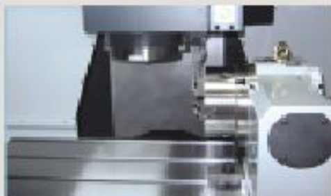
Установка дополнительной оси
