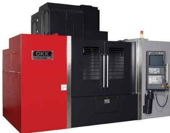
Согласно прогнозам компании ОКК последнее поколение станков серии VM – вертикальных обрабатывающих центров будет весьма востребована на рынке высокопроизводительного оборудования. Конструкция станков данной серии имеет высокую жесткость и точность, не только станины станка, стойки, но и шпиндельного узла с принудительным охлаждением, двухточечный контакт оправка - шпindel (конструкция Big Plus) с рабочим конусом BT 50, интенсивное охлаждение инструмента (СОЖ), узлов станка, ШВП.
