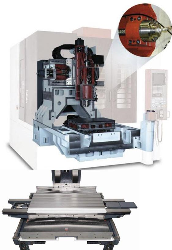
Станина коробчатой формы с увеличенными параметрами направляющих скольжения (увеличенная ширина и расстояние между ними) хорошо работают во всем диапазоне нагрузок.
