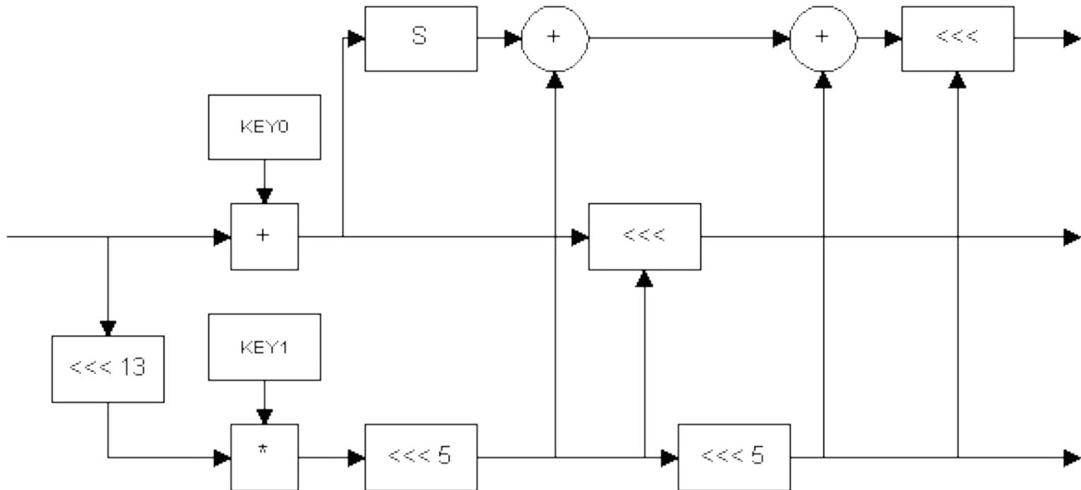
В алгоритме MARS использованы практически все виды операций, применяемых в криптографических преобразованиях : сложение, "исключающее ИЛИ", сдвиг на фиксированное число бит, сдвиг на переменное число бит, умножение и табличные подстановки.
