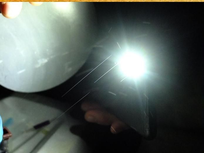
(Верхнее фото) Выдержка 2 мкс, капли на фото в правильной пропорции, сферические. Это позволяет определить их размеры. внутренний диаметр капилляра 0,3 мм, следовательно, капли в потоке имеют диаметр около 0,15 мм.
