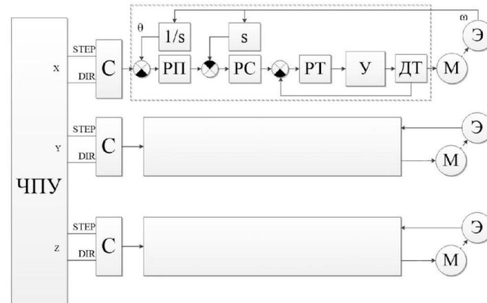
Рисунок 2 – Цифровой электропривод с управлением по положению
