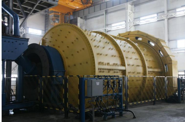
**Футеровка** должна обеспечивает защиту мелющего агрегата от повреждений механического, физического и химического характера. Конструкция плит для футеровки барабана мельницы должна быть легкоъемной.
