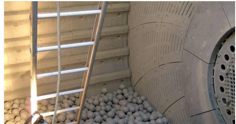
Рис 1.1 Внутренняя часть мельницы (Футеровка, Диафрагмы и мелющие шары)
