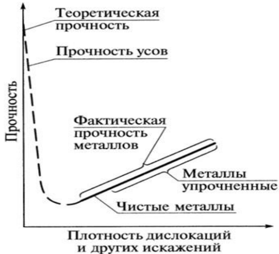
Рис. 2.8. Зависимость прочности металла от искажений кристаллической решетки
