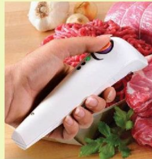
Детектор бактерий SensorFreshQ определяет свежесть мяса по запаху.
