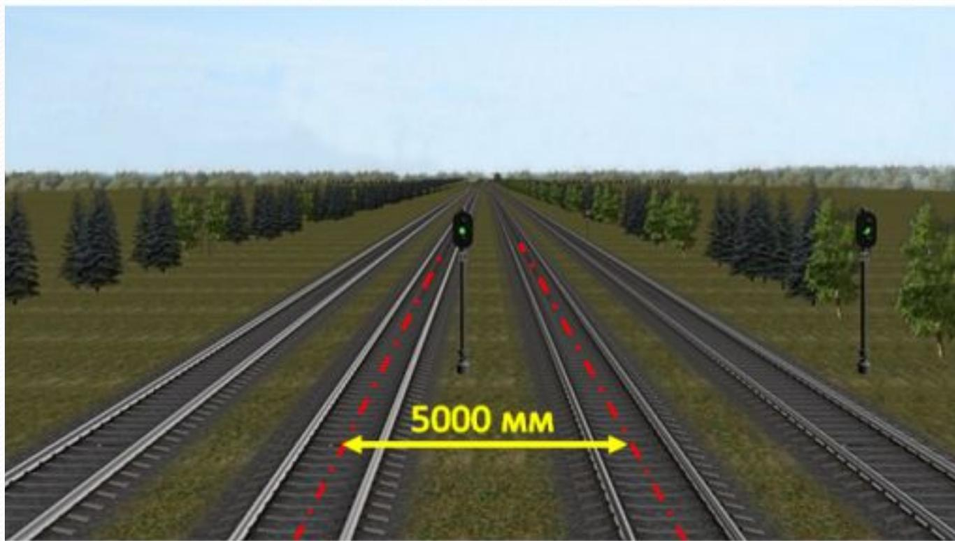
Расстояние между осями смежных железнодорожных путей на железнодорожных станциях, прямых участках должно быть **не менее 4800 мм**, на второстепенных железнодорожных путях (железнодорожные пути стоянки железнодорожного подвижного состава, железнодорожные пути грузовых дворов) и железнодорожных путях грузовых районов **не менее 4500 мм**.
