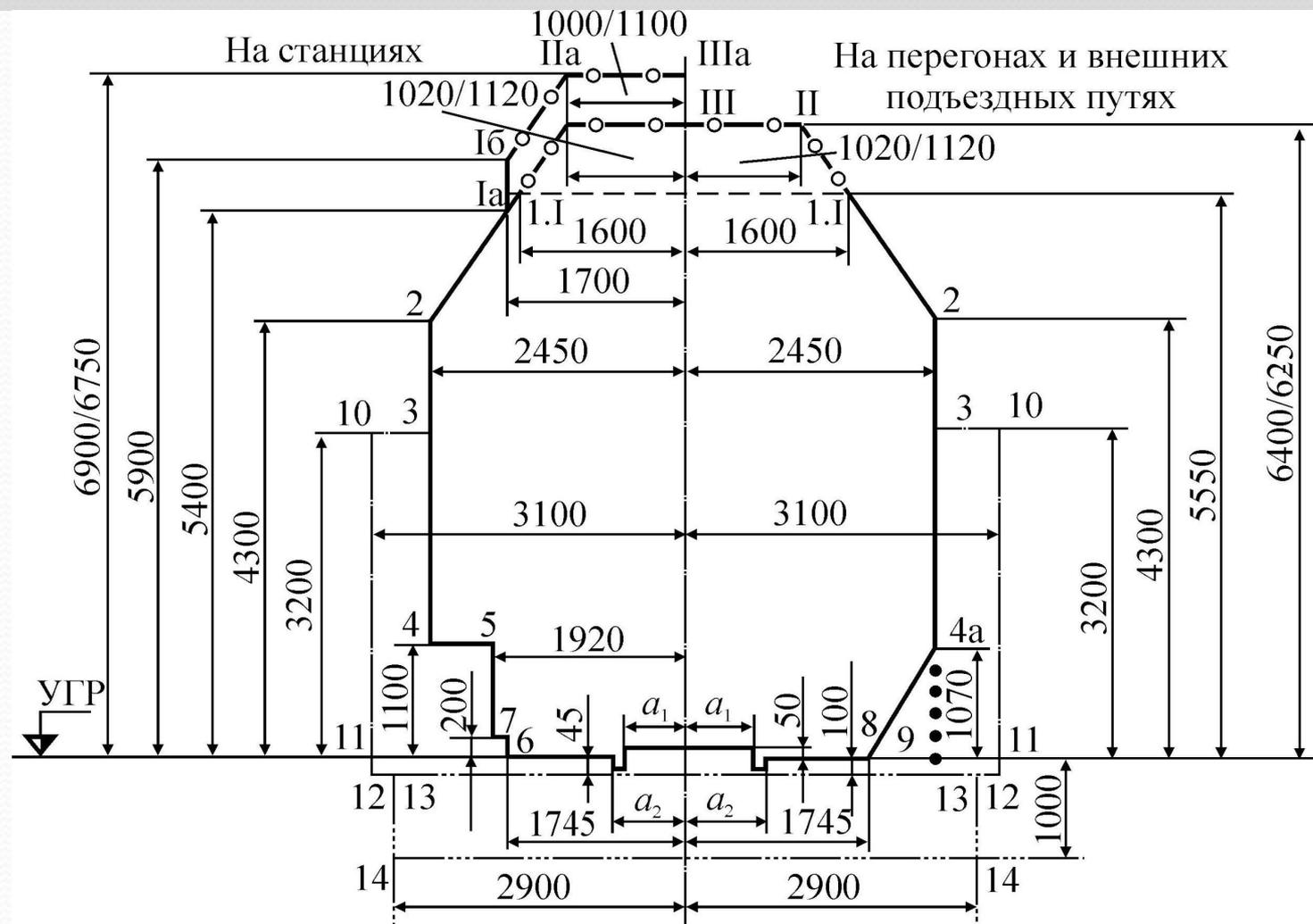
В габарите для перегонов на расстоянии от оси пути 1745 мм предусмотрен скос высотой 1070 мм от уровня верха головки рельса для перил на мостах, эстакадах и других искусственных сооружениях.
