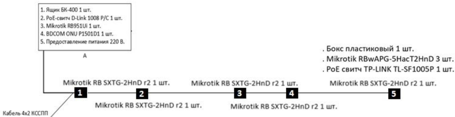
Соединение между оборудованием выполнено кабелем 4x2 КССПП (внешний 8-жильный кабель RG45 cat 5E).
