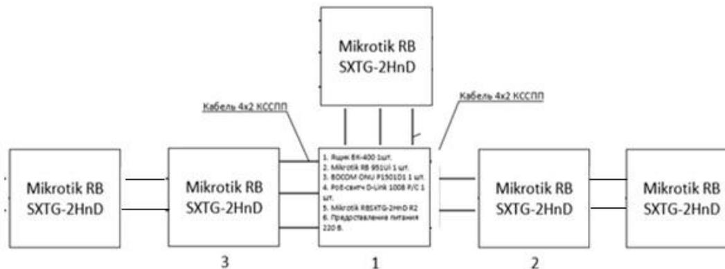
Соединение между точками размещения оборудования выполнено 8-жильным кабелем 4x2 КССПП (RG-45 cat 5E, уличный, на тросу).
